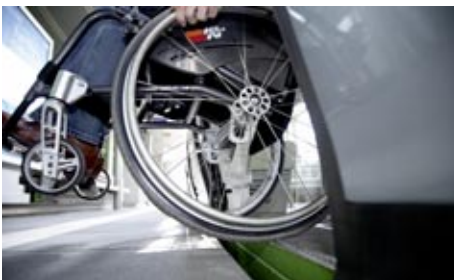
Barrierefreier Einstieg am Hochbahnsteig
